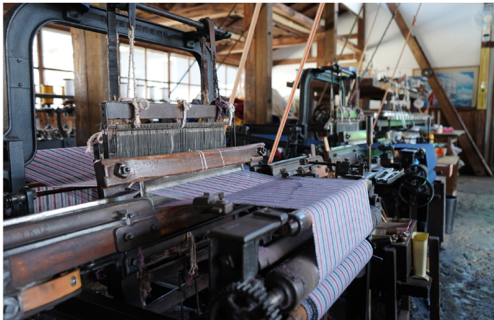
左/豊田式鉄製小幅動力織機（Y式）。豊田佐吉が1915年に開発した織機で、ガーゼなど薄地織物の生産に使われ、4万3千台が生産された。下/トヨタ自動車との接点のきっかけとなった中日新聞の記事。
