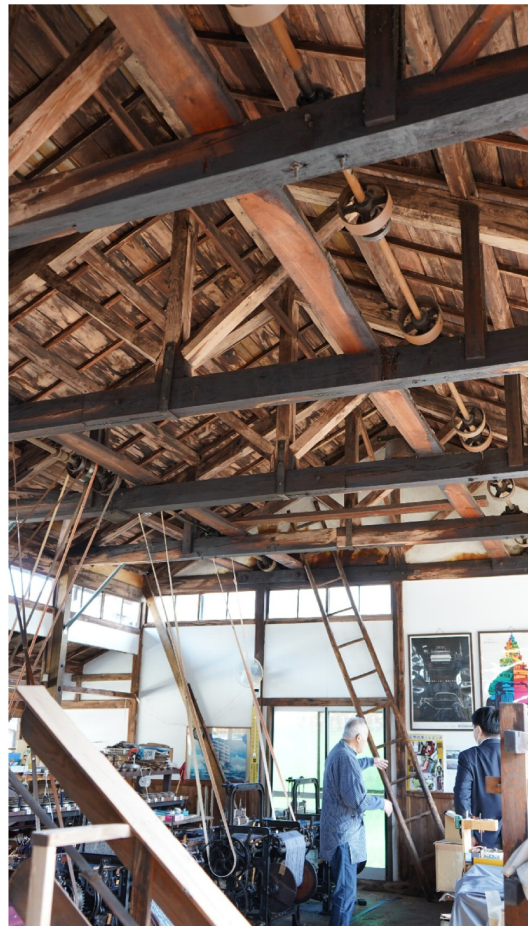
工場の入口にはモーターがあり、その動力が天井に吊るされたベルトに伝わって、織機が稼働する仕組み。
